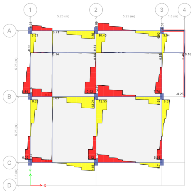
Diagramas de fuerza cortante en vigas de primer nivel (azotea). (t).
